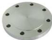
Usadas para interromper a passagem de fluidos em tubulações, válvulas e bombas. São usados também para facilitar a inspeção da linha. São recomendadas para trabalhos em qualquer situação de pressão e temperatura desde que não sujeitos a golpes de aríete (choques de pressão).
