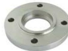
Esta flange é dotada de encaixe que recebe a tubulação a ser soldada, utilizando somente a solda externa. Facilita a condução de fluidos. São recomendados para trabalhos em qualquer situação de pressão e temperatura desde que não sujeitos a severos gradientes térmicos. Aplicável em pequenas bitolas.
