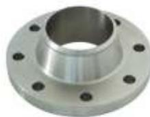
Esta flange recebe solda circunferencial no pescoço o que facilita o exame da solda por raio X. São resistentes à tensões e reduzem as turbulências e erosões dentro das tubulações. São recomendados para trabalhos em qualquer situação de temperatura e pressão.
