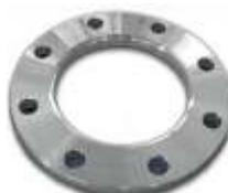
Estas flanges são apropriados para pestanas (stub-ends). Não são fixadas as tubulações por solda somente fixada ao outra flange por parafusos, o que é facilitado por estar solto na linha. Recomendadas para baixa pressão, pois são utilizados em linhas de aço inox trabalhando em conjunto as pestanas.
